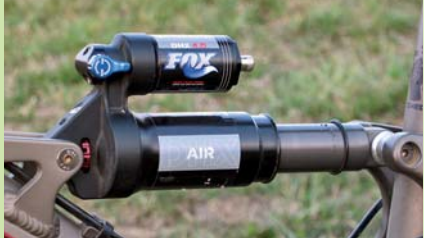
Moderní vzduchový tlumič pro freeride a sjezdové disciplíny vypadá díky přetlakové nádobce podobně jako pružinový vzor, jen ta pístnice je prostě silnější a hmotnost nižší.
