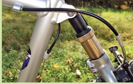
I toto je tlumič, byť se jedná o netlumivý elastomerový blok. Pro softtail rámy je to však dostačující řešení, v minulosti to byla často realita i pro biky s čepý a prepákováním.
