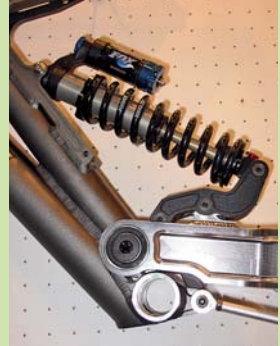
Vinutá pružina, dlouhé tělo a vysoká hodnota zdvihu, to je základ tlumiče pro sjezdová kola. Navíc čím delší tlumič a zdvih, tím lepší charakteristika, samozřejmě v určitém limitu. Hustota vinutých pružin rovněž dokáže ovlivnit celkovou progresivitu.
