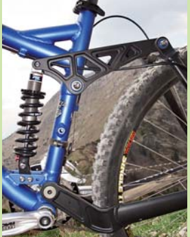
U kol se zdvihem kolem patnácti centimetrů už budou pružinové tlumiče brzy hubdou minulosti. Díky nižším nákladům na výrobu a těsnění tak zůstanou maximálně u supermarketových lowend kol. Ta dnes standardně nemají ani tlumení odskoku.
