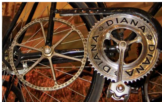
Německý bicykl Diana Special z roku 1894 využíval namísto běžného řetězu vložené kolo s vnitřním (cévovým) ozubením, které bylo uloženo v samostatné vidlici.
